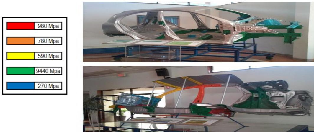
*Ilustración 1.5 Componentes en carrocería y su nivel de soporte*
